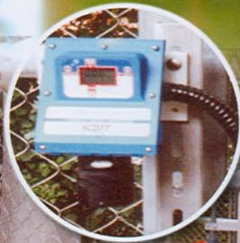
環境臭氧濃度警報設備
