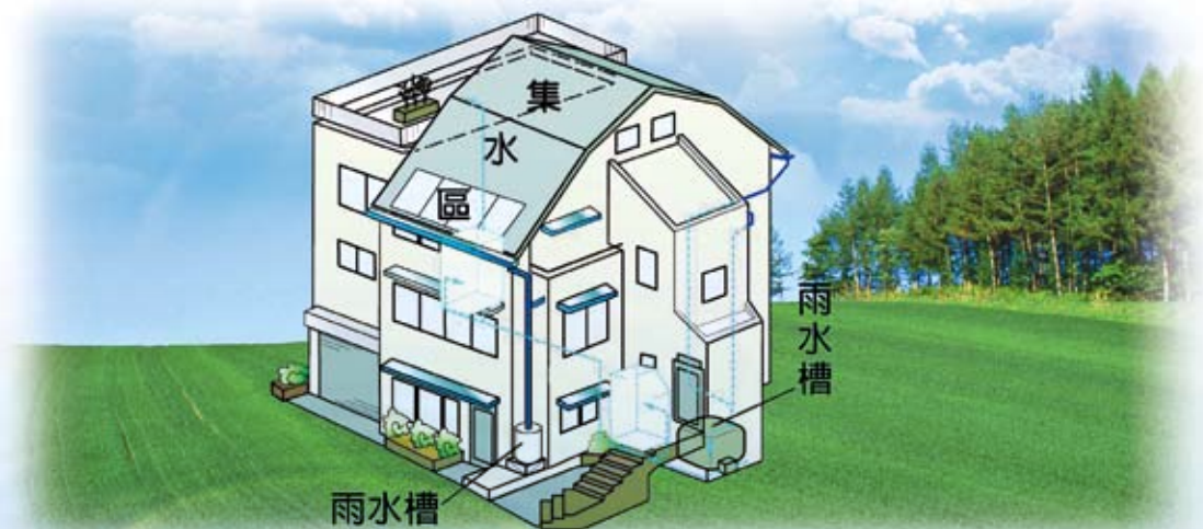
雨水貯留利用示意圖
