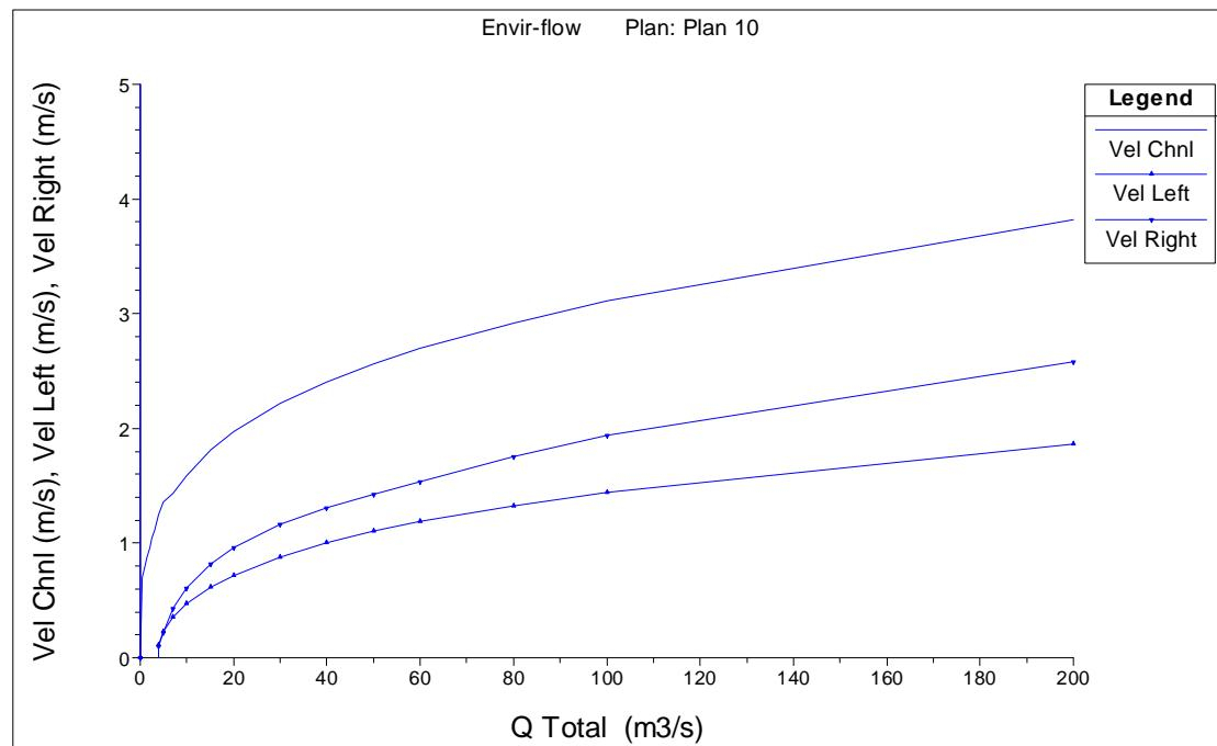
圖 16. 流速率定曲線
