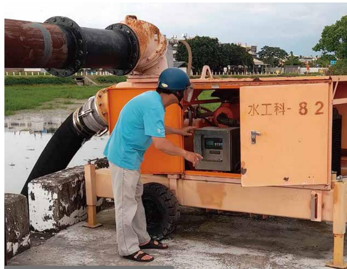
第六大隊防汛護水志工巡檢12英吋大型移動式抽水機
