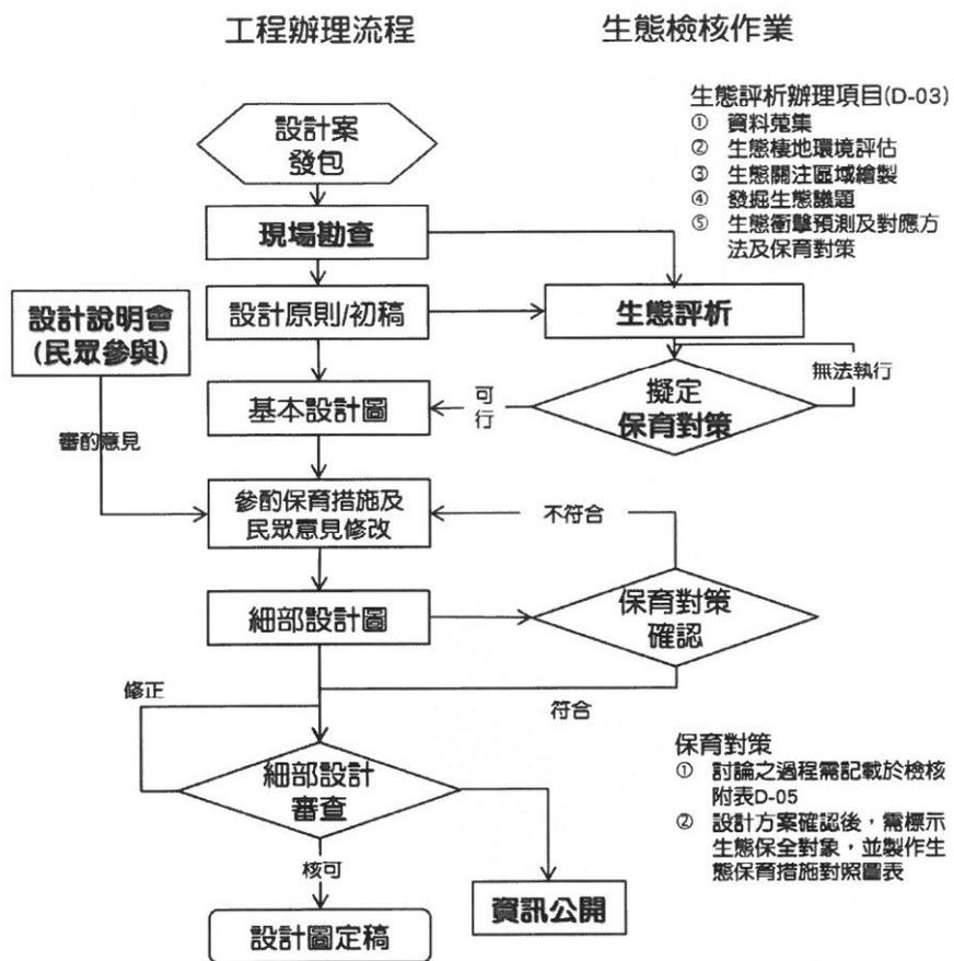
圖二、規劃設計階段生態評估流程圖
