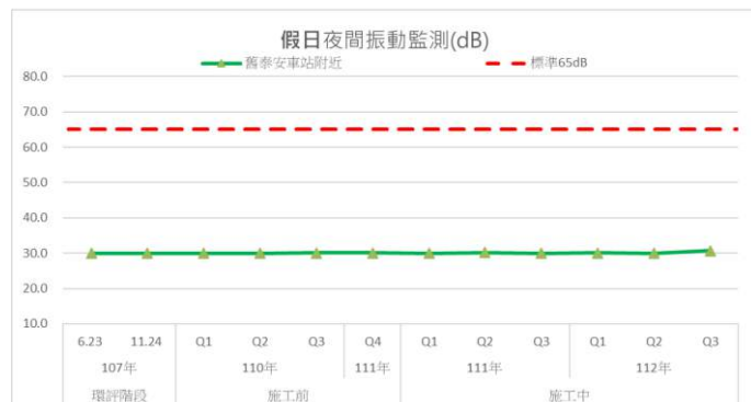
圖3.1.1-9 歷次舊泰安車站附近測站振動監測結果變化情形
