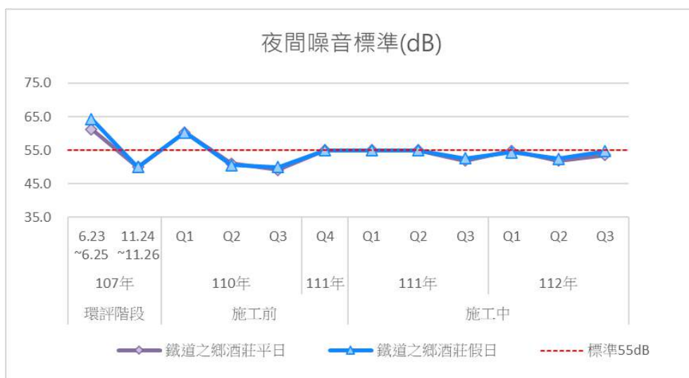
圖3.1.1-6 歷次鐵道之鄉酒莊測站噪音監測結果變化情形
