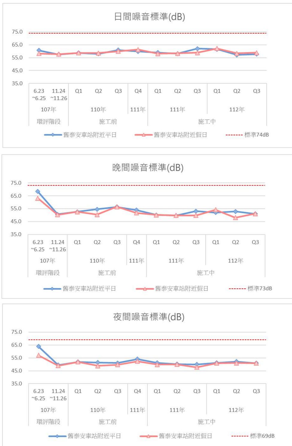
圖3.1.1-3 歷次舊泰安車站附近測站噪音監測結果變化情形
