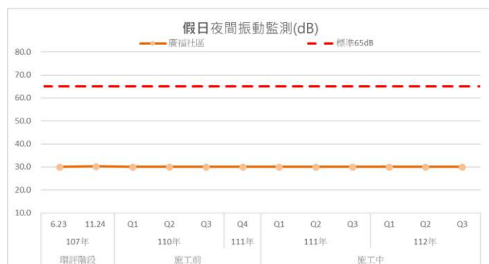
圖3.1.1-11 歷次廣福社區測站振動監測結果變化情形
