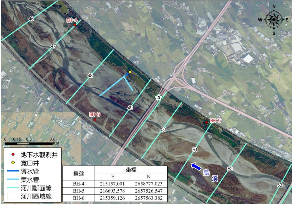
圖 2.1-1 本工程設置地下水觀測井位置圖
