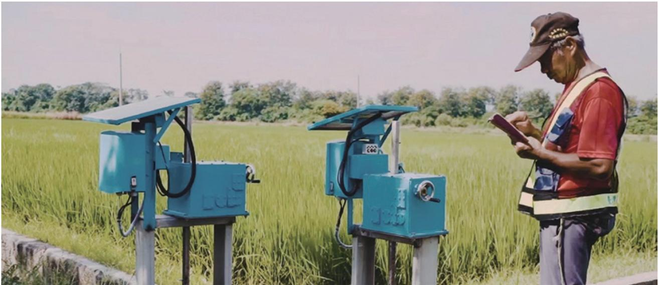
圖 2、掌水工遙控智慧化分水設備水門
