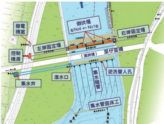
圖 1 羅東攔河堰伏流水工程配置圖
