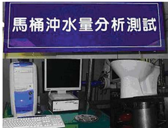
節水實驗室馬桶沖水量測試設備
