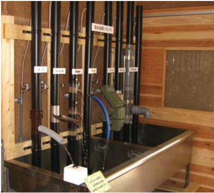
各型雨水過濾器，參觀者可自行操作以了解雨水過濾器之效果及安裝方式。
