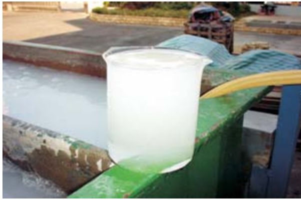
圖 6 奈米浮除製造氣泡之效果
