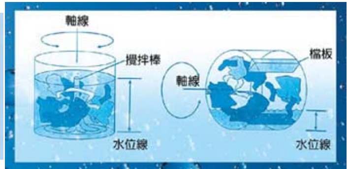
▲ 圖 3 垂直式與水平式水位線之比較
