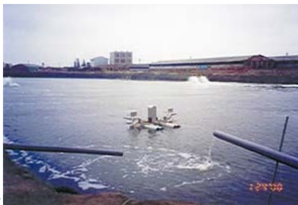
▲ 圖 7 「生物處理法」循環水系統利用水車形成環繞式低流速水流, 將污水集中至水池中央
