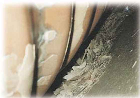
▲ 安裝永磁式磁能處理器後煙管水垢大量剝落
