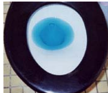
▶圖 8. 步驟四 漏水現象水封呈現藍色
