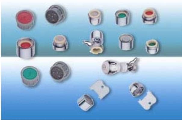
水龍頭流量決定於水壓高低及出水管徑大小，一般供水壓力住戶較難自行控制，因此水龍頭節水多從縮小管徑著手。縮小管徑最便捷的方式係在水龍頭前端起泡器內加裝適當孔徑之節水片。
