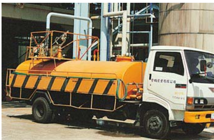
圖 11 處理後廢水提供廠區道路灑水草木灌溉用
