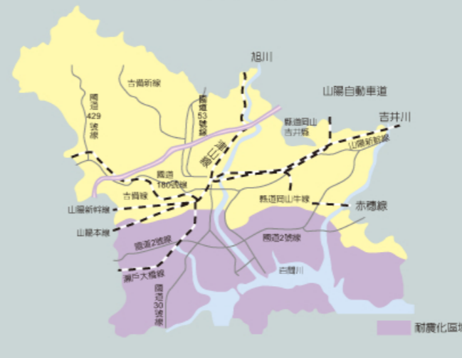
圖10 岡山市水道管路耐震化規劃圖
