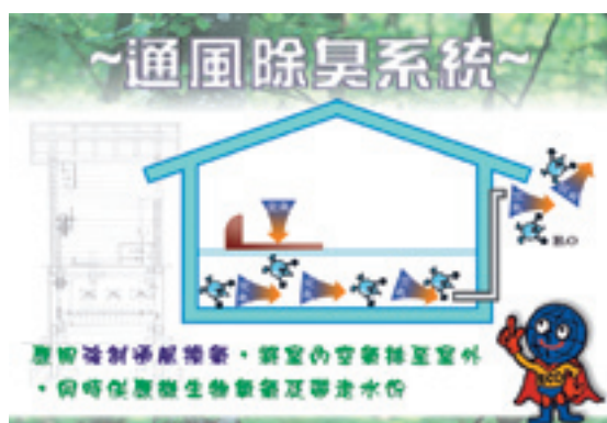
圖2.生態化乾式廁所通風除臭方式
