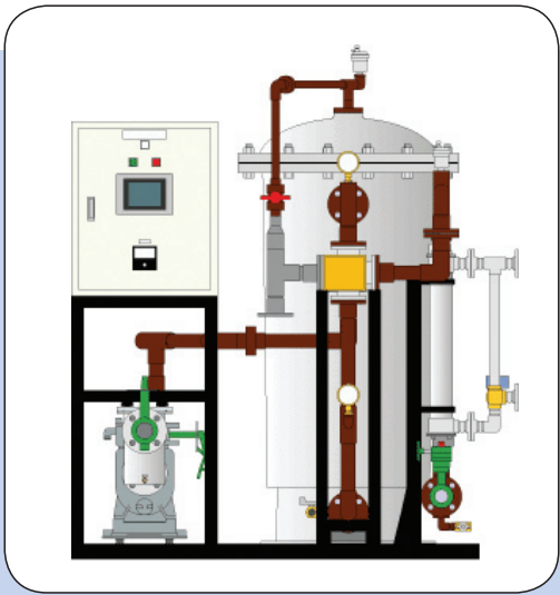
圖6 客製化溫泉循環設施
