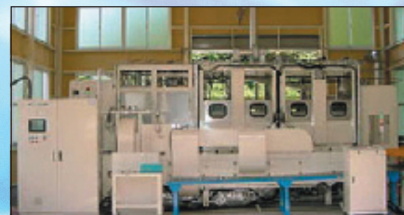
特殊電解離子水脫脂洗淨設備
