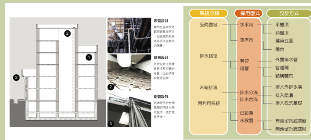
圖2 既存之建築雨排水系統概要
