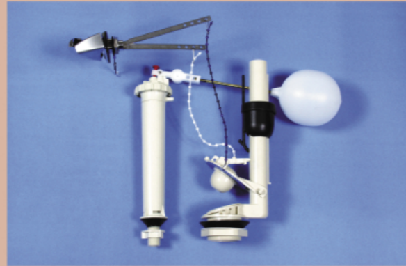
圖7 利用重力浮球推壓方式之特殊兩段式沖水器
