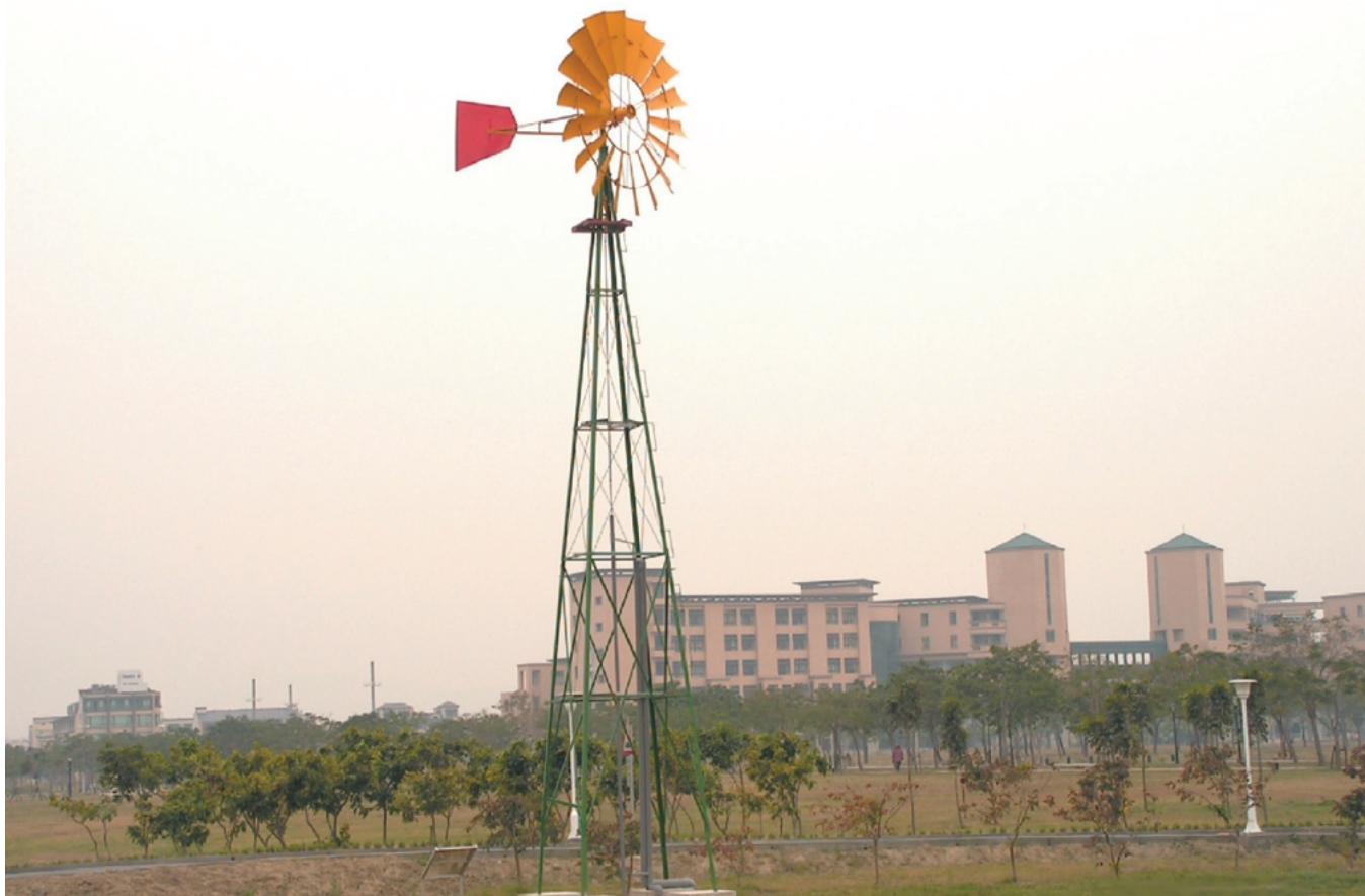
3m直徑葉片之風車汲水設施每年僅需更換一次齒輪油即可，維修相當簡便
