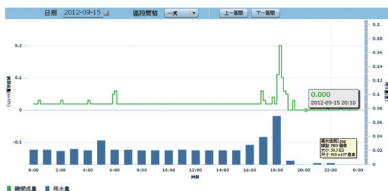
(圖五) 通知用戶進行檢修，9/15 用戶於 19:00 修漏完畢
