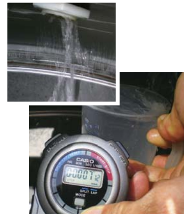
圖八 R.O回收水進水量(每小時0.26m 3 )
