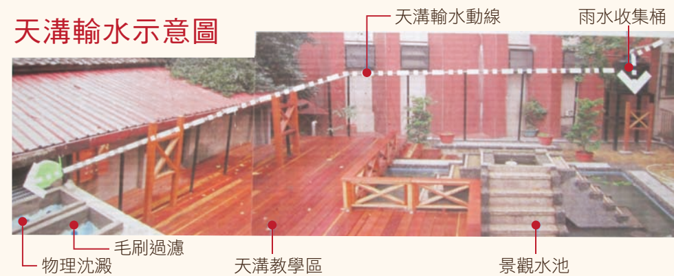
圖七 天溝輸水示意圖
