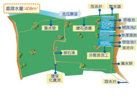
**14號場址**集水面積約為1.5公頃，設定目標處理水量為暴雨發生所產生逕流量408CMD。經處理後總磷去除率可達40%，懸浮固體去除率可達60%，生化需氧量去除率可達50%。
