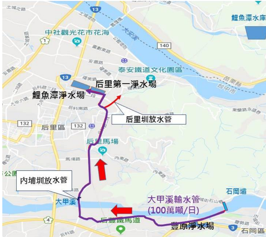
圖4-11大甲溪有餘裕流量時操作示意圖
