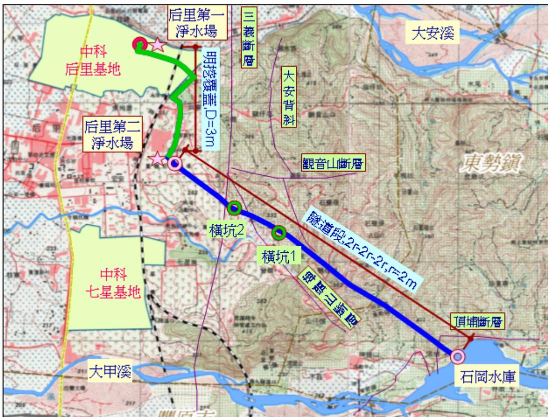
圖5-1-2 「大甲溪輸水路」路線方案二平面示意圖
