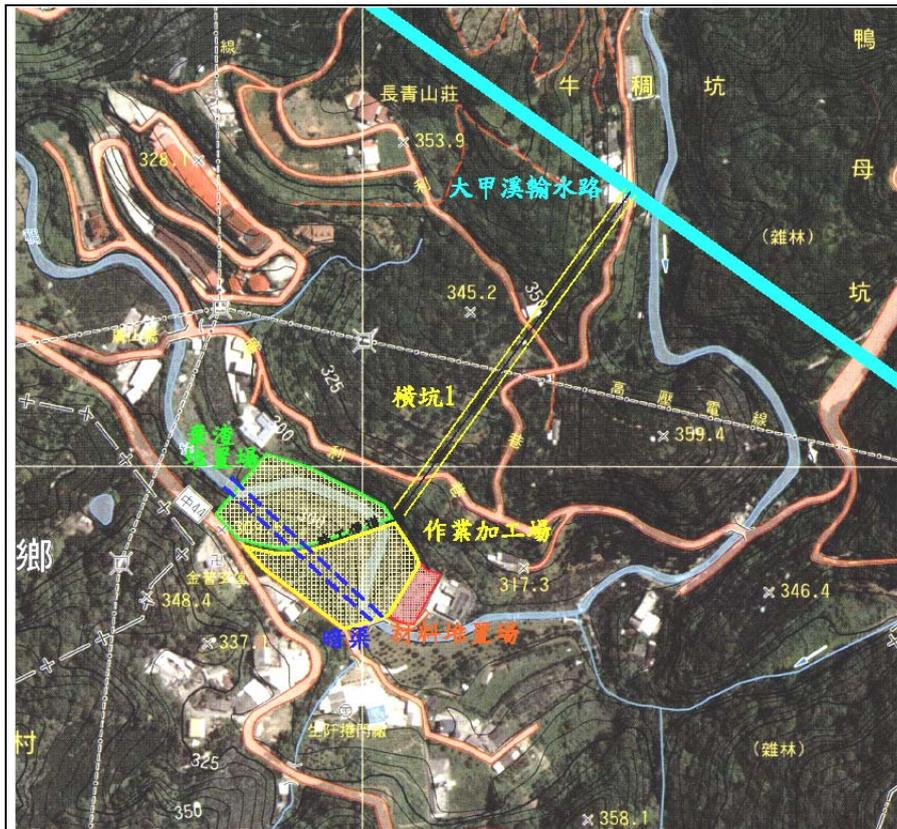
圖 8-2-1 大甲溪輸水路工程橫坑 1 洞口佈置示意圖
