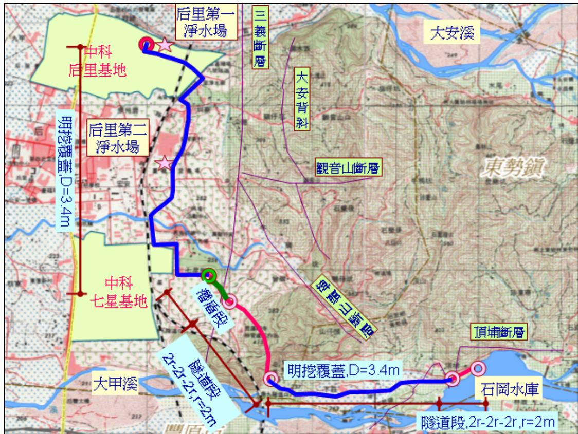
圖5-1-3 「大甲溪輸水路」路線方案三平面示意圖
