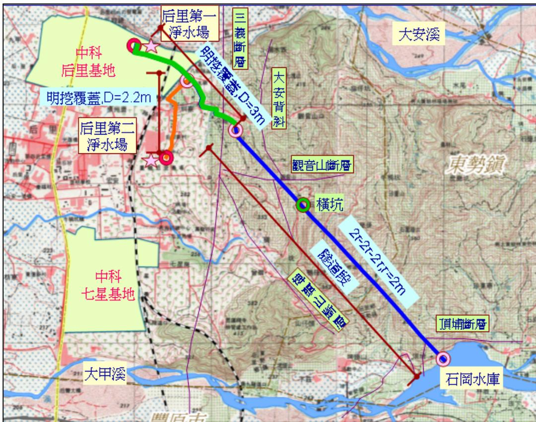
圖5-1-1 「大甲溪輸水路」路線方案一平面示意圖
