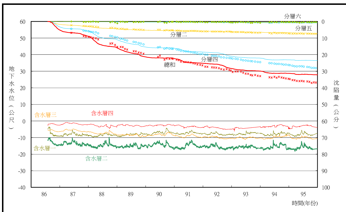
圖 6.1-1 新街國小黏土層壓密參數優選之累計壓密量與監測值比較圖(2/4)
